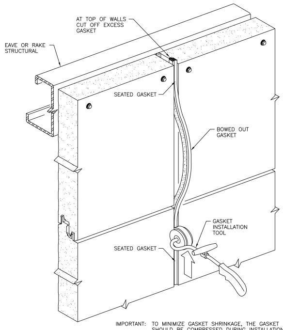
IMPORTANT: TO MINIMIZE GASKET SHRINKAGE, THE GASKET SHOULD BE COMPRESSED DURING INSTALLATION. LEAVE PORTIONS OF THE GASKET BOWED OUT, THEN PUSH INTO PLACE TO COMPRESS THE GASKET.
